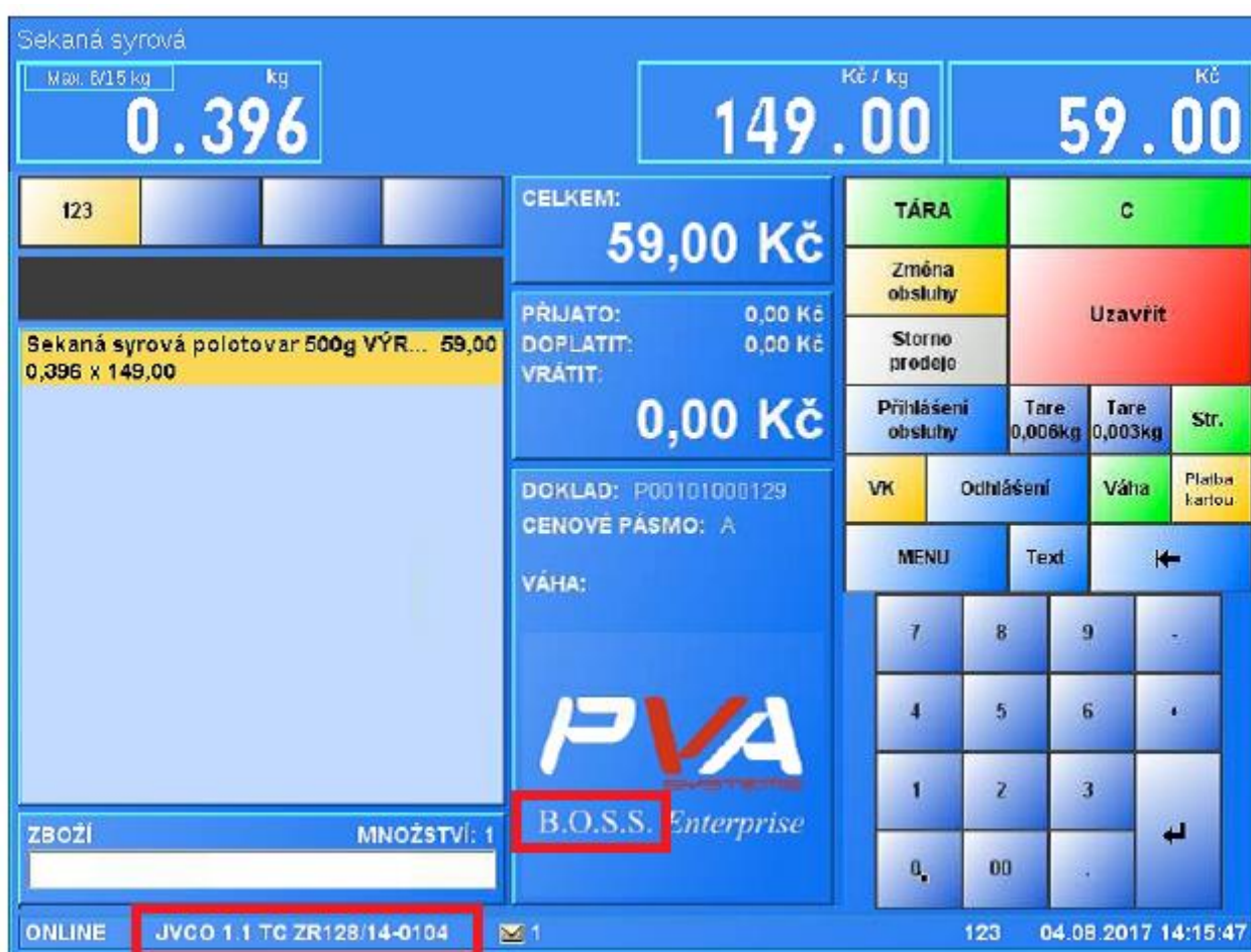
Obrázek 1: Příklad rozvržení uživatelského displeje v OS Windows 7, včetně zobrazení názvu aplikace, legálně relevantního modulu, jeho verze a čísla certifikátu
