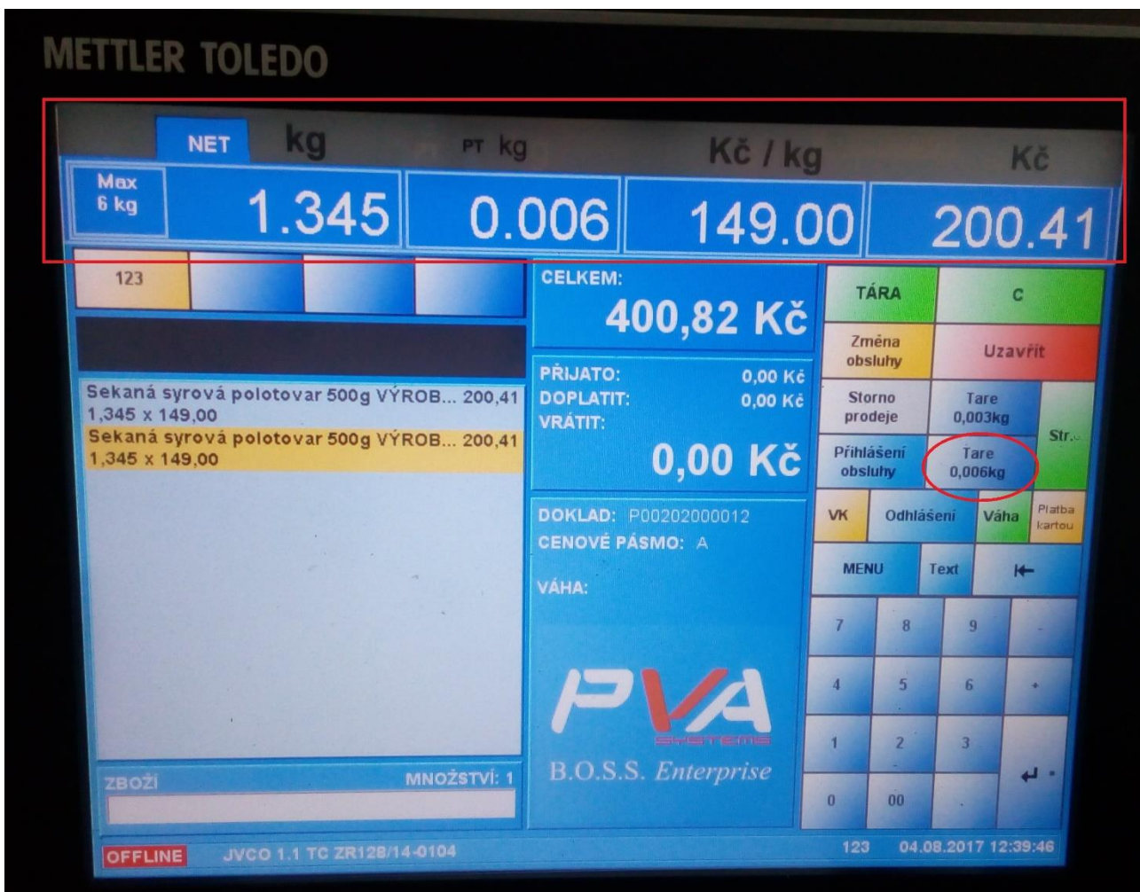
Obrázek 4: Uživatelský displej, OS Windows XP – prodej vážené položky s předvolenou tárou a funkční tlačítko předvolené táry
