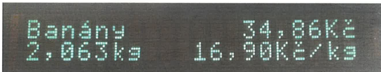
Obrázek 1: Zákaznický displej 2x20 znaků – zobrazení primárních indikací
